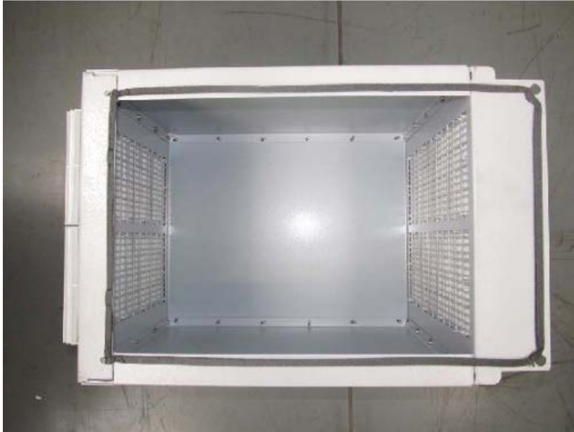
Рисунок 8-61 Верхний кожух с приклеенной уплотнительной лентой
