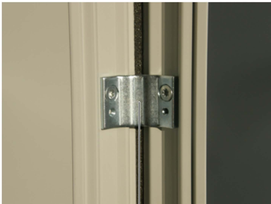
Соединители внешние момент затяжки: 9 Нм
